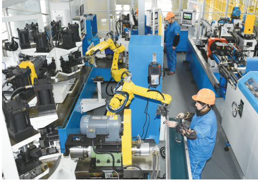
2月14日，在位于浙江省湖州市吴兴区的金洲管道科技股份有限公司，工作人员和智能机器人协作生产不锈钢管件。新华社发
