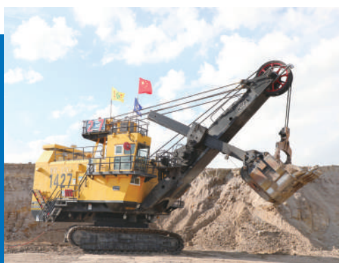
太重远程操作智能化挖掘机交付现场,基于5G网络,操作人员可以精准操控数十公里之外的挖掘机现场作业。 新华社发
