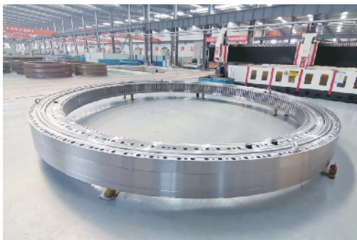
我国自主研发的超大型盾构机用直径8米主轴承(中科院金属研究所供图)。
