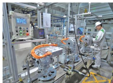
日本电产汽车马达工厂车间，工作人员正在装配新能源电驱动装置。新华社发
