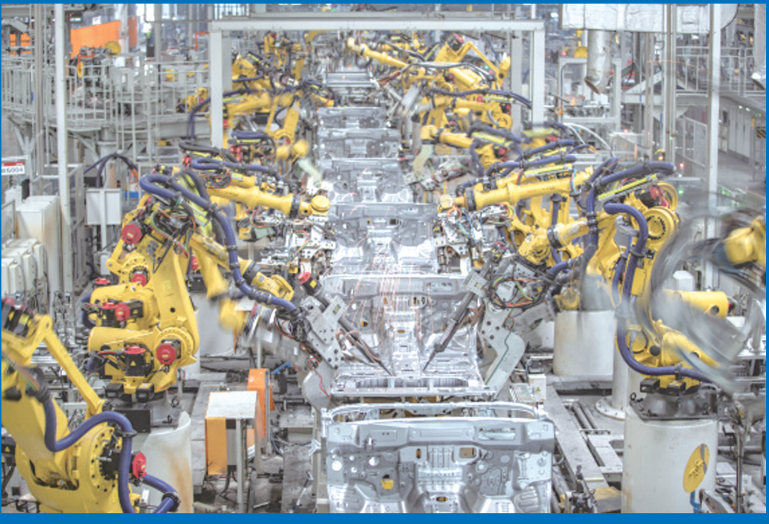
在长城汽车重庆永川生产基地焊装车间,智能化焊接机器人正在进行焊接作业。新华社发
