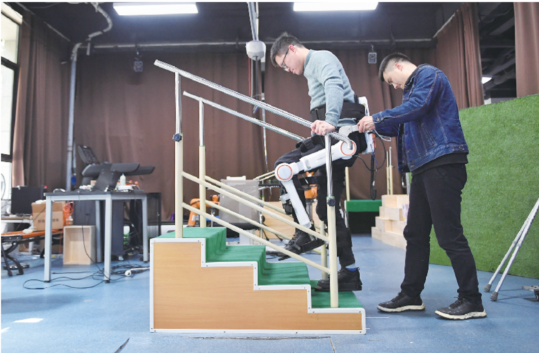
3月6日,电子科技大学机器人研究中心科研人员在帮一名截瘫患者体验外骨骼机器人上下楼梯康复训练功能。 新华社发
