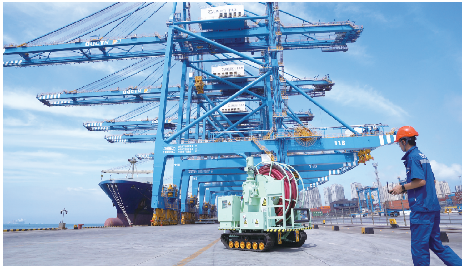
在山东港口青岛港自动化码头,工人正在遥控岸电机机器人前往船边,给货轮充电。
